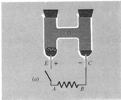
FIGURA 4.18 Distribuzione del potenziale a circuito aperto. Lo zero della scala del potenziale
